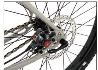
メンテナンスが容易な メカニカルディスクブレーキ(AVID BB7)
